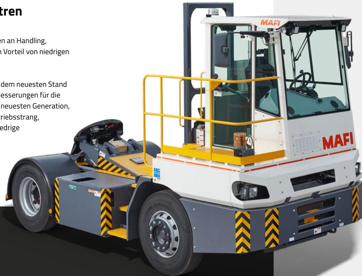
Die Terminal-Zugmaschine war ursprünglich für den Containerumschlag in Seehäfen konzipiert. Sie wird aber auch für industrielle Transportaufgaben verwendet, bei denen schwere Lasten bewegt werden müssen.
