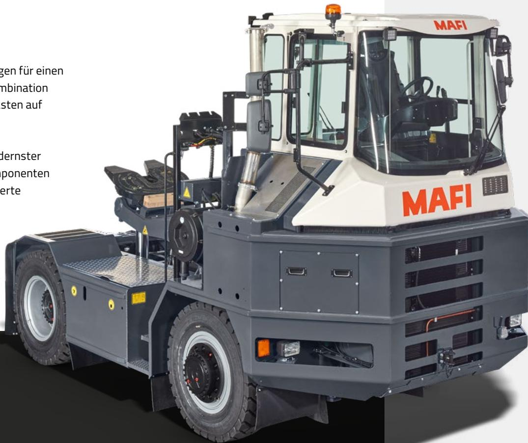
Der HD 445 ist das leistungsstärkste und größte Fahrzeug von MAFI. Mit einer anhebbaren Sattelast von 45 Tonnen wird er hauptsächlich in Stahlwerken, Gießereien und anderen Schwerindustrien eingesetzt.
