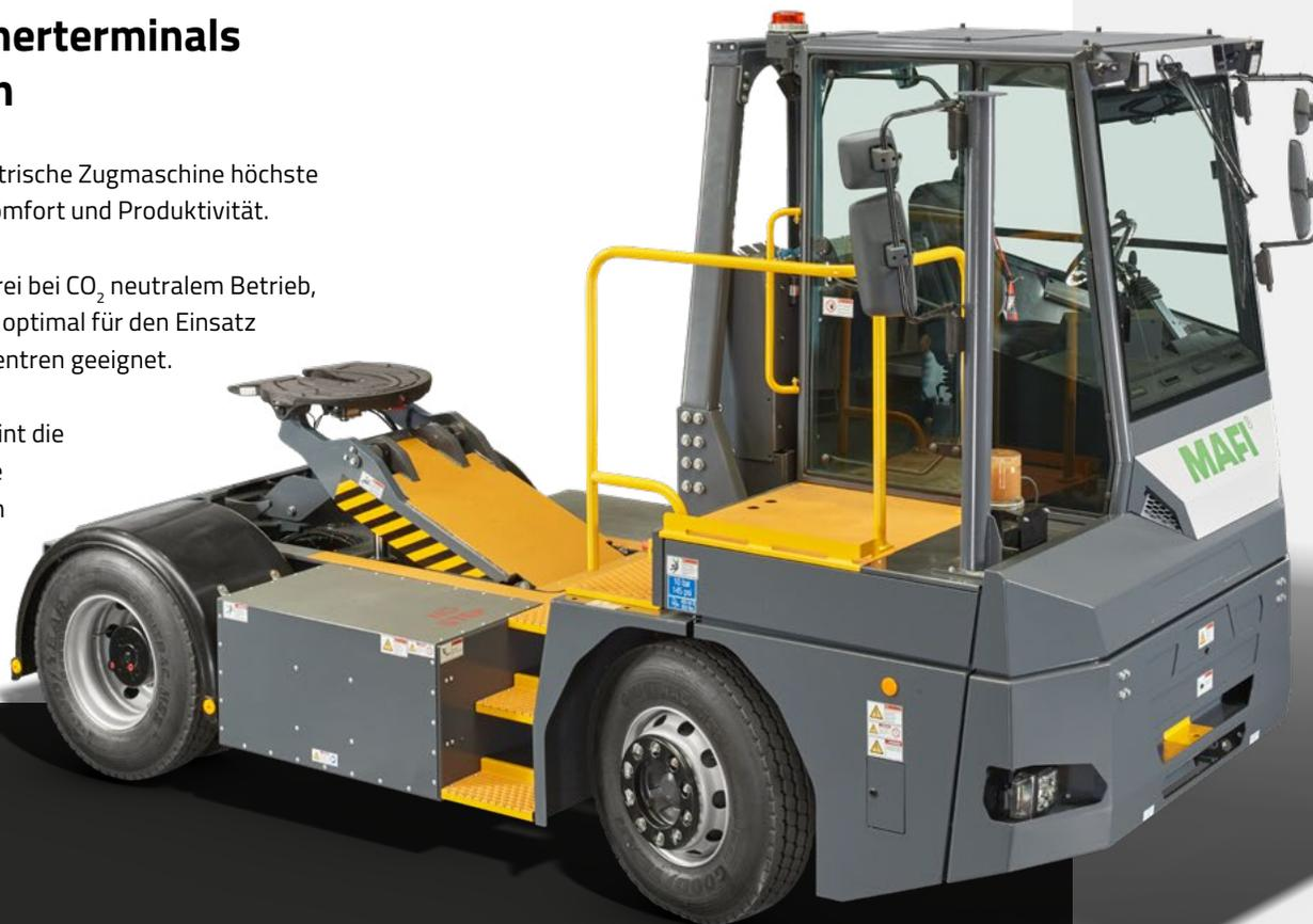
Die elektrische Terminal-Zugmaschine wurde für den Containerumschlag in Seehäfen konzipiert. Auch in der Industrie findet sie Ihre Anwendung zum Umsetzen von schweren Lasten.
